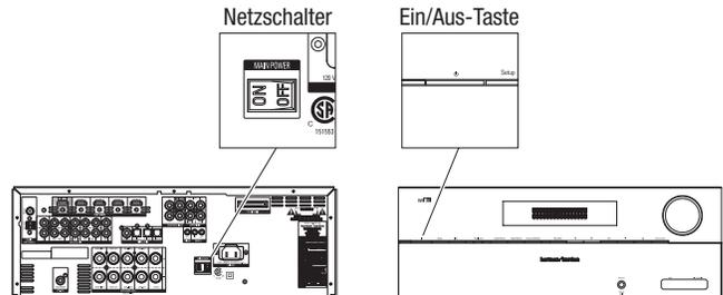
Schalten Sie den Netzschalter am AVR nur aus, wenn Sie das Gerät einmal längere Zeit nicht benutzen wollen (z.B. wenn sie in den Urlaub fahren). Lassen Sie den Netzschalter sonst immer eingeschaltet (On). Schalten Sie den Netzschalter aus, bleiben Ihre gewählten Einstellungen noch bis zu vier Wochen erhalten.
